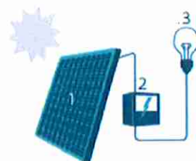
1. Zonnepaneel | 2. Omvormer | 3. Elektrische toestellen
